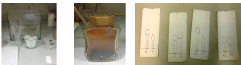
Figura 1: Avaliação do biodiesel preparado por cromatografia em camada fina
